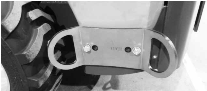
Staffa di ancoraggio A418623 installata lateralmente al telaio posteriore. Per l'installazione laterale, sono necessarie due staffe.
